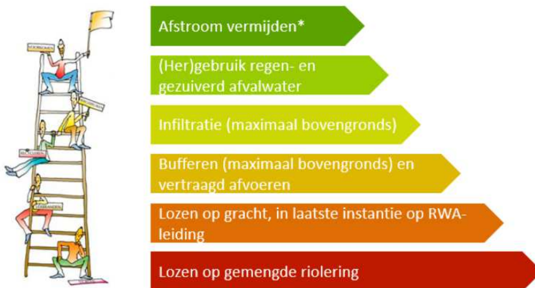
Figuur 76. Ladder van Lansink, toegepast op hemelwaterbeheer (CIW, 2021).
