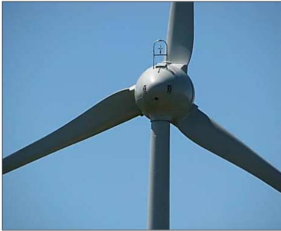
Figuur 6 : Windrichtingsmeter grootschalige windturbine horizontale as
