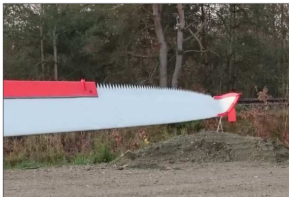
Figuur 20: Serrations op het uiteinde van de wiek
